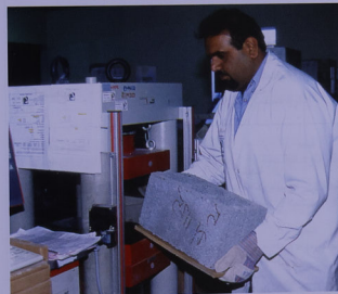
قياس درجة تحمل الطابوق في مختبر المواد الهندسية
