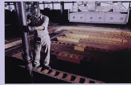
يتم تجفيف كتل الأنود لمدة 17 يوما لتتحول الى أقطاب كربونية صلبة ومقاومة للحرارة وموصلة فعالة للتيار الكهربائي . The green anodes are baked for 17 days to form solid, heat resistant and electricaly conductive carbon anodes.
