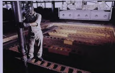
يتم تجفيف كتل الأود لمدة ١٧ يوما لتتولد في القطاب كربونية صلبة ومقاومة لحرارة وموصلة فعالة للتيار الكهربائي. The green anodes are baked for 17 days to form solid, heat resistant and electrically conductive carbon anodes.
