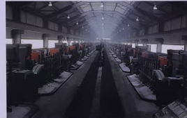
توجد في عتابر المصهر ٦٨٤ خلية مبطنة بالكربون، ينساب تيار كهربي مباشر من أقطاب الأنود الى الكاثود في الخلية وذلك لفصل الأومينا الى أكسجين والنيوم
