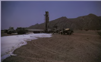
حفارة تقوم بحفر بئر استكشافية Rig drilling exploration hole
