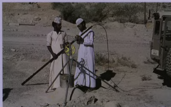
تجهيز مسير للاختبار الجيوفيزيائي لتلقب الحفر Preparing geophysical probe for insertion into observation well
