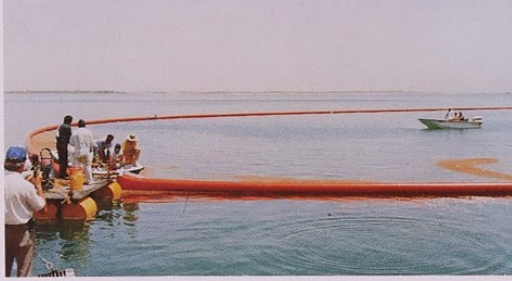
منظر من الجو بين انسكاب نفط مصطنع يتم تجميعه داخل حاجز على شكل الرقم (٧) جاهز للصخ داخل الصندل العائم باستخدام مكشطة.
