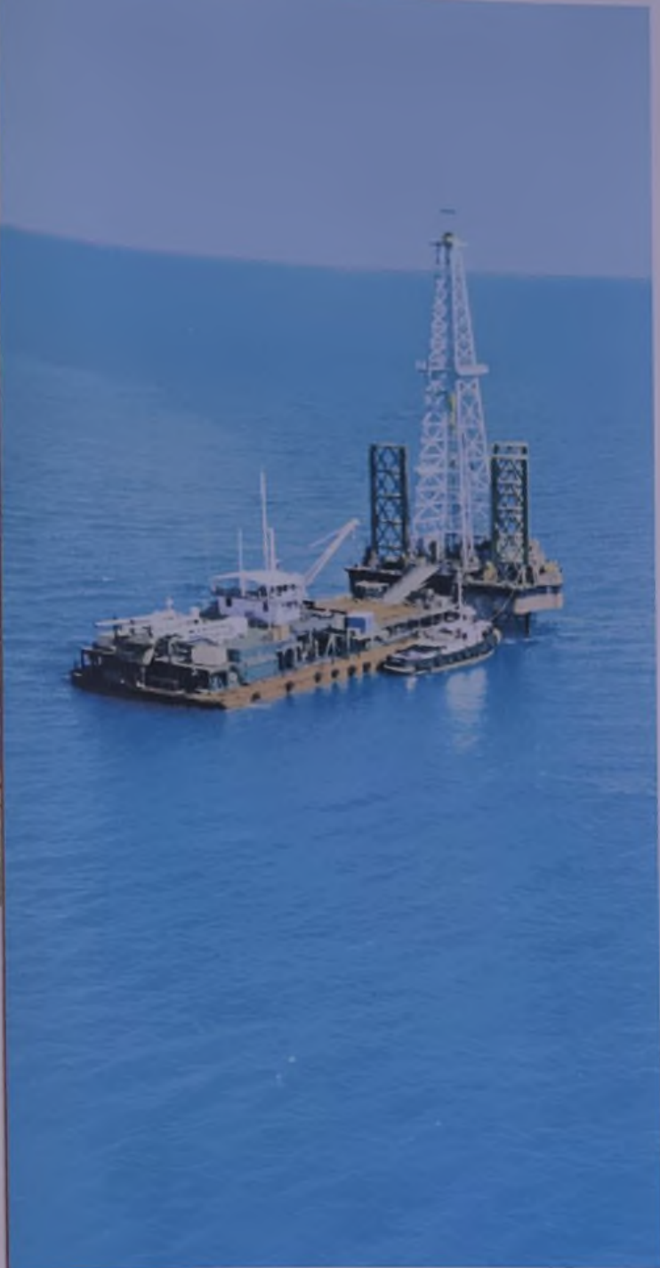
قاعدة الحفر المتنقلة في أثناء عملها مع مركب الحفر « كوين ماري » ( الى اليسار ) في منيفة
