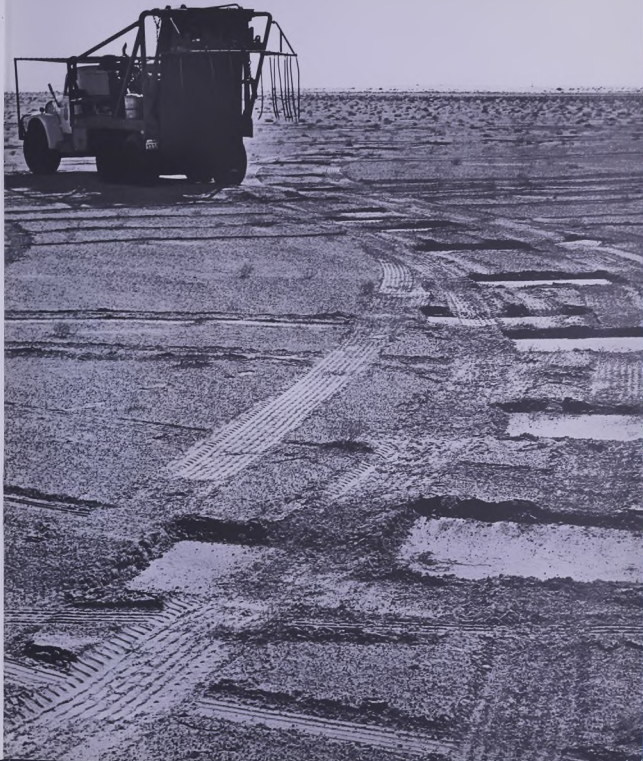
الظامة - وهي جهاز لقياس الاهتزازات الأرضية يستعمل لأول مرة في المملكة - تتلطف الكهنة في بلاد الصحراء .
