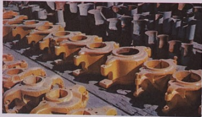
الدهان يقي لوازم الحفر من التآكل. Paint protects drilling supplies from corrosion.
