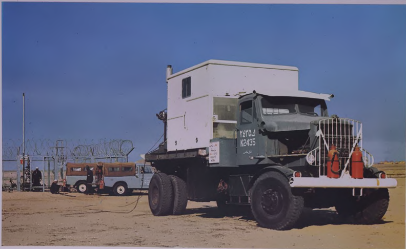
تركيب معدات للكشف على طبقة التقاء النفط بالماء في احد الابار
