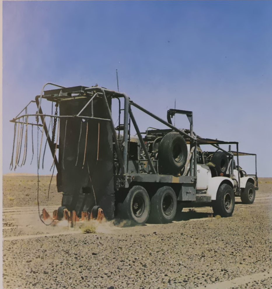
شاحنة خاصة باسقاط الثقل تابعة لفريق مسح زلزالي دفن مقياس الاهتزازات
