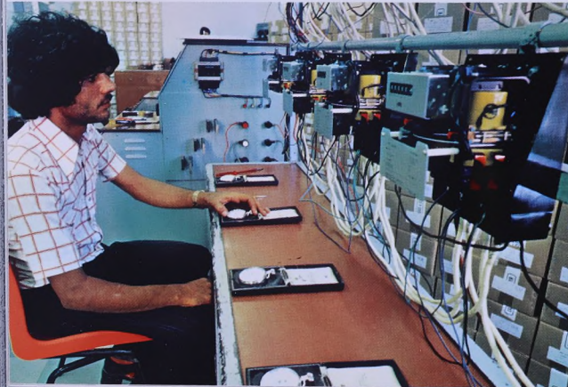
اختبار العدادات للتأكد من مقياسها قبل تركيبها لدى المستهلكين
