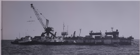
تمه خطوط الانابيب تحت مياه البحر بواسطة هذا الصنل لعمل على رفع طاقة الإنتاج من حقل السفانية ال ٣٢٥ ٠٠٠ برميل في اليوم .
