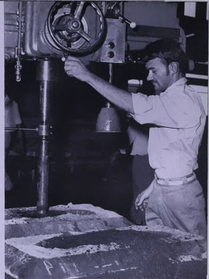
مؤلف قيد التدريب يستخرج عينة جوفية للتحليل من احد قوالب الانود المنصهرة في اثناء مستعملا متفقا لاصاف نظري مع متف ماسي .
