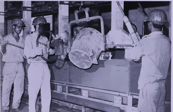
مؤلف قيد التدريب يستخرج عينة جوفية للتحليل من احد قوالب الانود المنصهرة في اثناء مستعملا متفقا لاصاف نظري مع متف ماسي .
