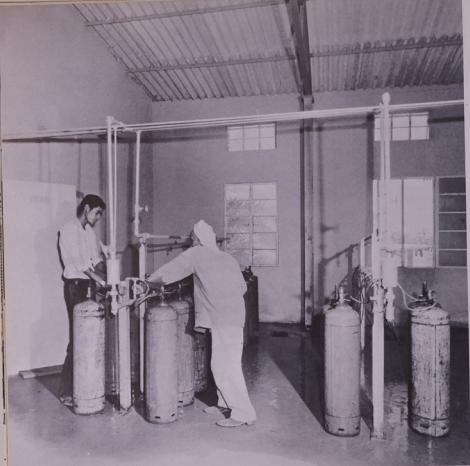
● معمل غاز الاسيتلين الذي تبلغ طاقته الانتاجية ٢٠ اسطوانة كل ٨ ساعات A
