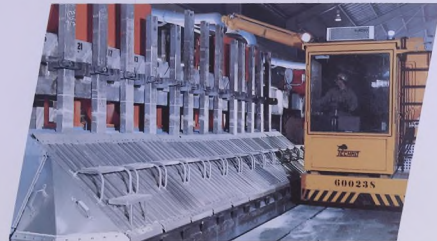
الانداد بالاكسجين يتم عبر احد الروافد فوق الخلية . وبالتالي فان التغذية يتحكم فيها كوميبيوتر دقيق يجعل معدل التركيز الاقويما ثابتا
