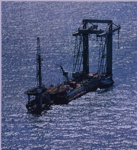
جهد ومهارة طاقم حفر مشاق لتحميل البارجة في حقل أبو سفاه. An offshore mobile rig and barge drill a well in the Abu Sa'fah field.
