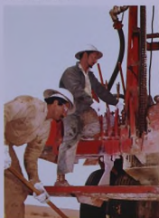
اثنان من الحاديين يحفران ثغوراً طرية لغرض استخدامها لفرق التلصيق في إحداث البشائر لقياس الاهتزازات الأرضية . Drillers dig shallow holes for explosive charges used by seismic exploration crew.
