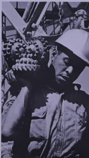
أحد عمال أجهزة الحفر يحمل مثقب الحفر . Rigman carries a drilling bit.
